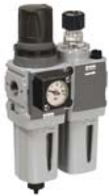
过滤器/减压阀 + 油雾器 组合 + 聚乙烯水杯 5 μ滤芯, 8 bar减压阀 + 压力表和墙式安装支架 进气口压力 10 bar, 出气口压力 6.3 bar, 1 bar压降。
