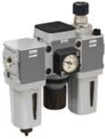
过滤器 + 减压阀 + 油雾器 组合 + 聚乙烯水杯 5 μ滤芯, 8 bar 减压阀 + 压力表和墙式安装支架 进气口压力10 bar, 出气口压力 6.3 bar, 1 bar压降
